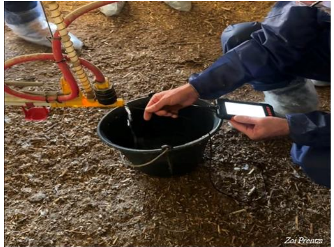
Überwachung der Biofilmbildung im Wassersystem mit dem Endoskop.
