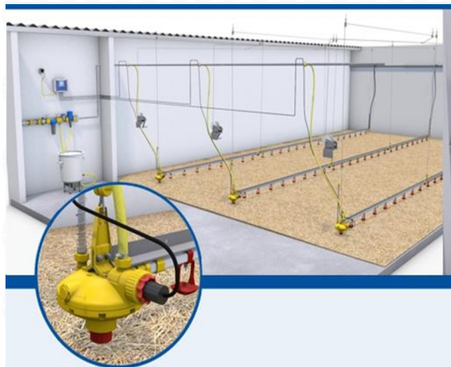
Automatyczny system płukania, LUBING.
